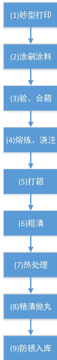
图 1.1 壳体铸造生产工艺流程图
