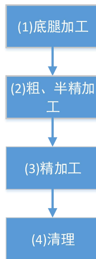
图 1.2 壳体加工生产工艺流程图
