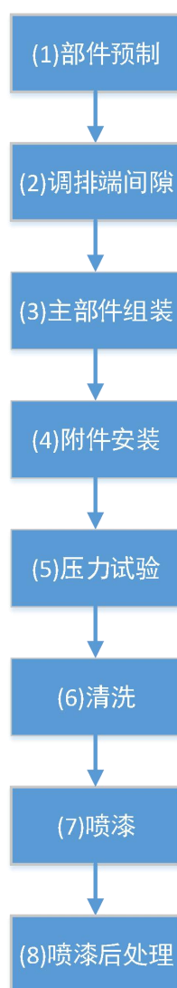
图 1.3 压缩机装配工艺流程图
